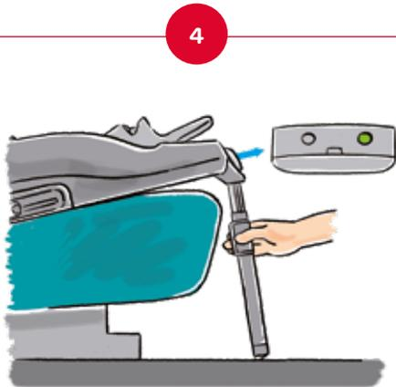
Réglez la longueur du pied d'appui de manière à ce qu'il soit bien en appui sur le plancher du véhicule comme décrit dans le mode d'emploi.
