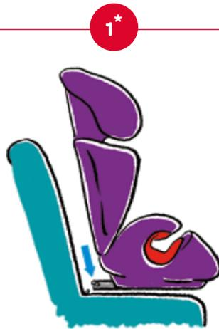
Votre rehausseur a des fixations Isofix ? Attachez-les aux points de fixation Isofix de la voiture si elle en est équipée.
