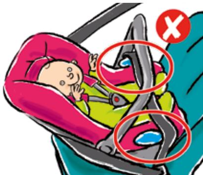
Le siège est mal attaché dans la voiture car la ceinture ne passe pas dans les encoches prévues à cet effet.
