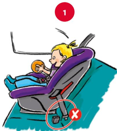
Le siège est mal fixé dans la voiture (ex. on n'a pas bouclé la ceinture).
