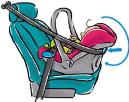
Insérez cette partie de ceinture dans l'encoche qui se trouve à l'arrière du siège ou sur le côté du dossier.
