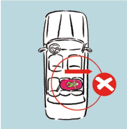
Les nacelles doivent être installées sur la banquette dans le sens de la longueur de celle-ci. En outre, placez toujours la nacelle avec la tête du bébé vers l'intérieur de la voiture.
