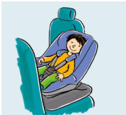
Suivant l'homologation, un siège du groupe 1 peut être installé dos à la route ou face à la route. Vérifiez bien cela dans le mode d'emploi car le siège doit être installé dans le sens pour lequel il est homologué.
