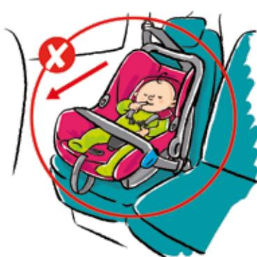
Le siège est placé dans le mauvais sens.
