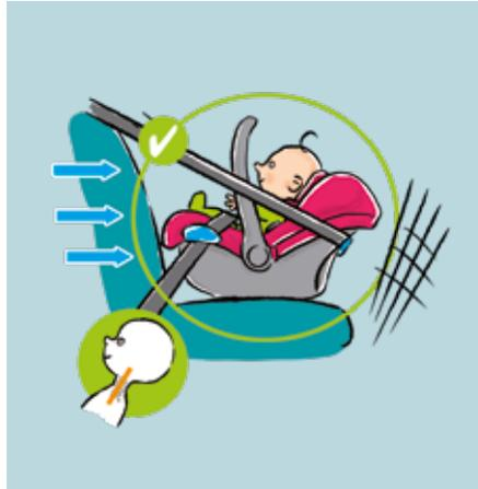
En installant un bébé dos à la route (donc avec la tête orientée vers la vitre arrière de la voiture), lors d'une collision frontale, la tête et le tronc du bébé sont en appui contre le dossier du siège. Le choc est donc réparti. Cela limite le mouvement de la tête et du cou. Le risque de lésions cervicales diminue donc fortement.
