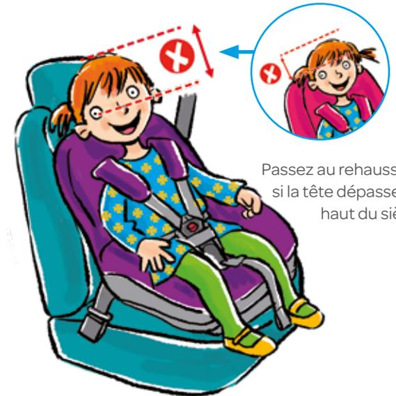
Passez au rehausseur si la tête dépasse du haut du siège.
