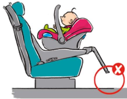
Le système anti-basculement (= pied d'appui) n'est pas utilisé avec le système Isofix.
